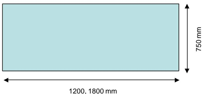
I piani sono provvisti di bordi perimetrali anti debordanti, lo spessore complessivo del piano e' di 45 mm.
